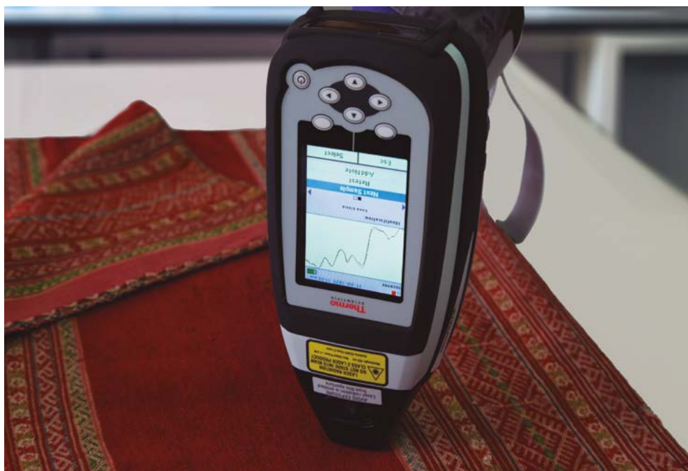
Figura 3: Análisis de muestras de textil por medio de espectrometría infrarrojo (NIR's).
